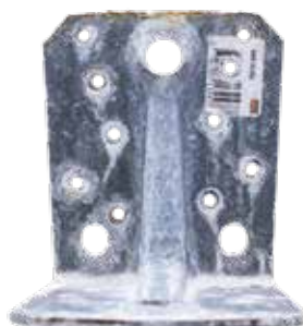
Connecteur revêtu de ZPRO® La rouille au sommet de la pièce a été recouverte par une couche protectrice de magnésium.
