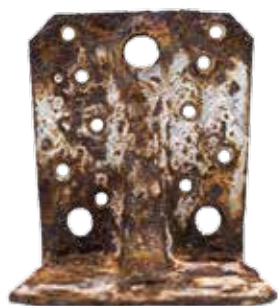
Connecteur en acier pré-galvanisé Z275 Une grande partie du connecteur est totalement rouillée.
