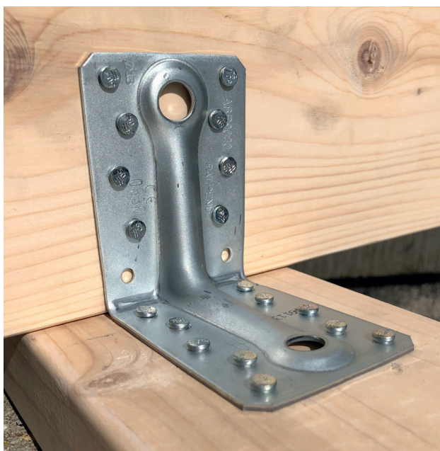
Équerre renforcée ABR9020 installée avec des pointes connecteurs CNA4.0X50.
